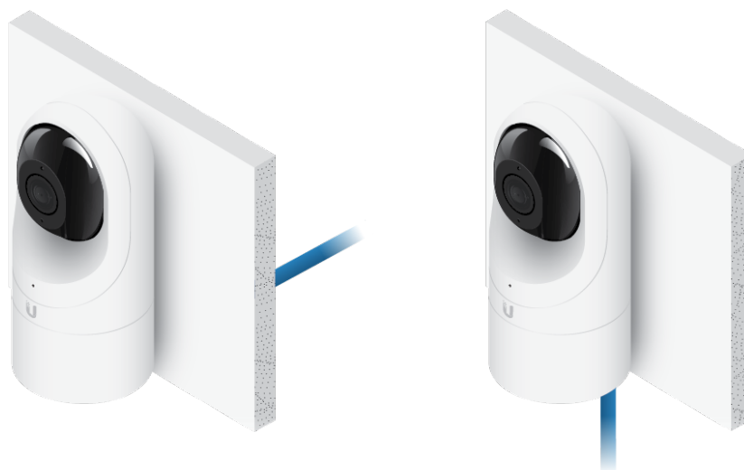
Ściana wewnętrzna z montażem podtynkowym
